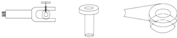
图 3 U 型卡槽、颈套、氟橡胶底座装置
