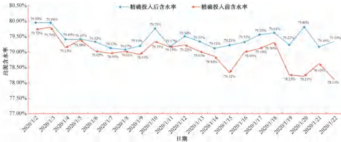
图 5 精确控制系统投入前后污泥含水率变化
