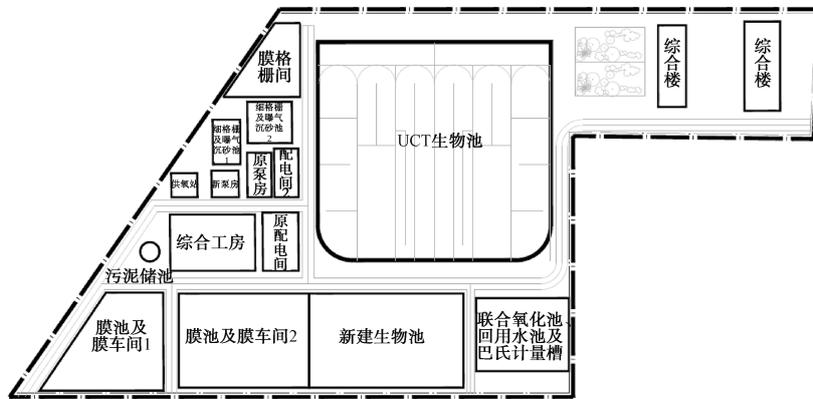
图 3 污水处理厂改造后平面布置
