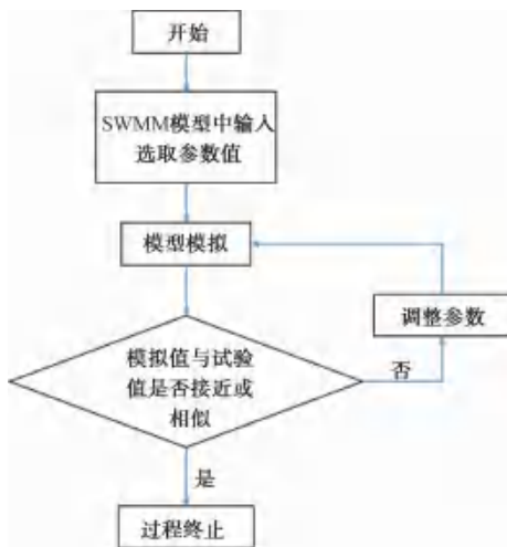
图4 遗传算法率定参数框架结构
