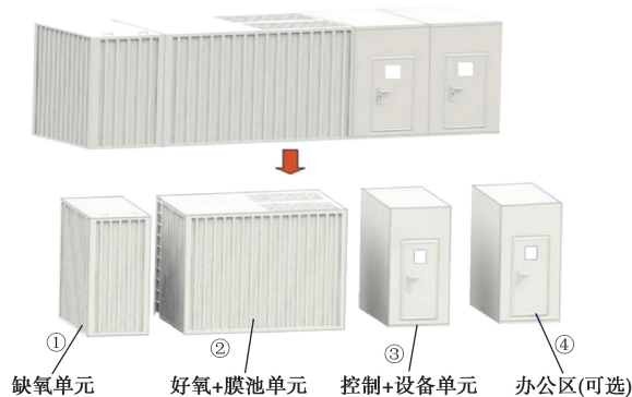
图2 一体化污水净化系统模块单元
