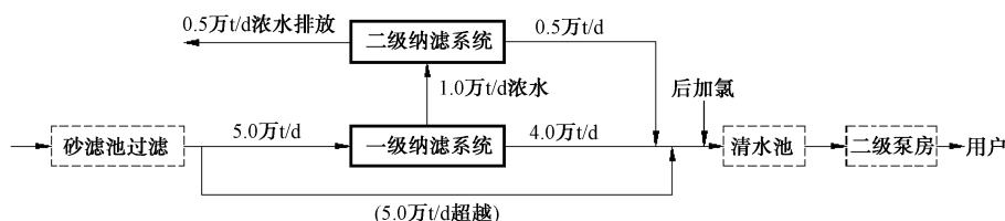
图 1 纳滤膜深度处理工艺流程
