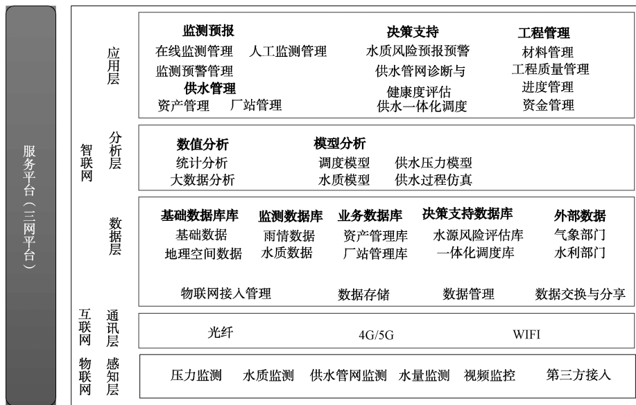
图 6 城市供水管家服务平台总体框架
