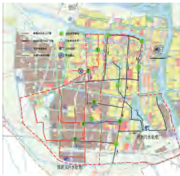
图 2 厂网联排系统布置
