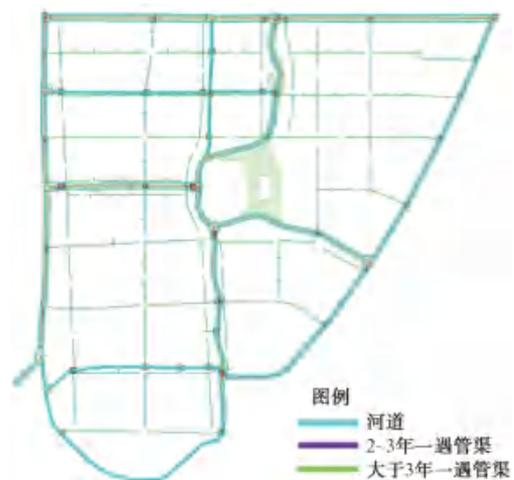
图2 雨水管渠排水能力评估
