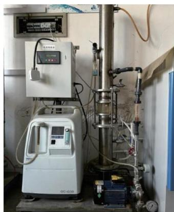
图 1 微纳米气泡臭氧灭活试验装置
