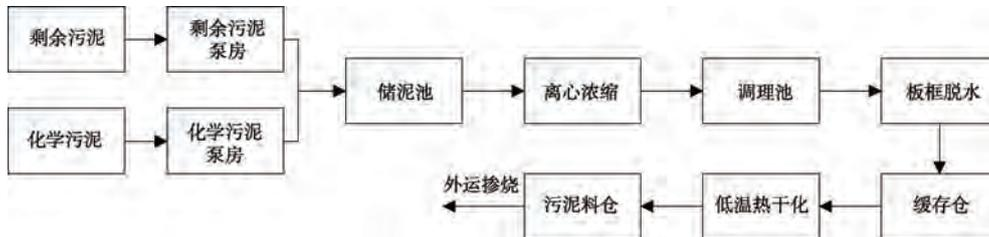
图 8 污泥处理处置工艺流程
