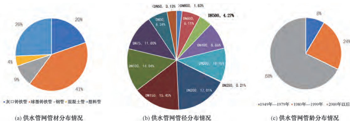
图1 A市供水管网管材、管径、管龄分布
