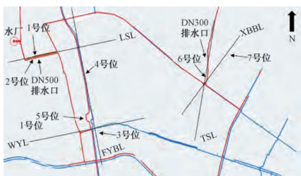
图6 供水管网勾点工程临时监测点 GIS
