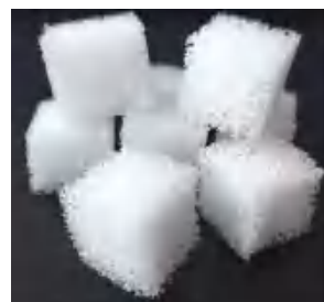
图4 改性聚氨酯填料的实物
