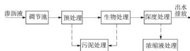
图1 生活垃圾渗沥液常规处理工艺流程
