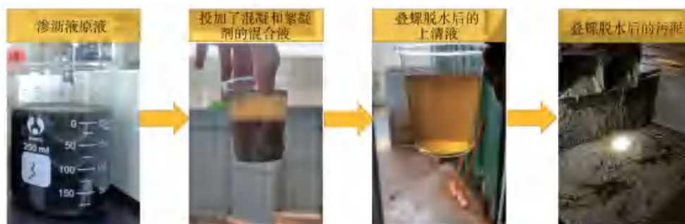
图 3 混凝沉淀预处理工段处理前后渗沥液颜色变化
