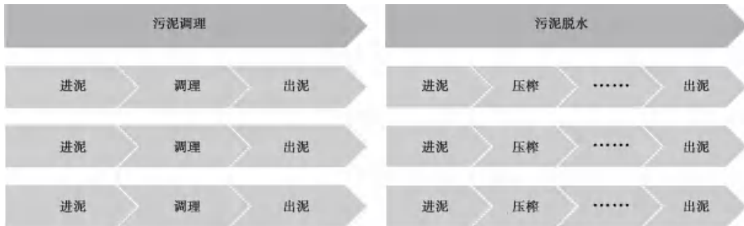
图 4 板框压滤机同步启动流程
