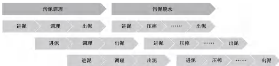
图2 板框压滤机依次启动流程
