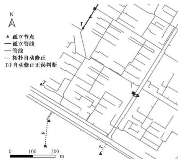
图7 管网拓扑自动修正判断结果(部分区域)
