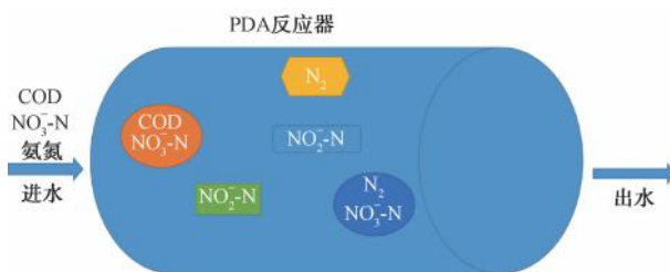
图3 一体式 PDA 工艺原理
