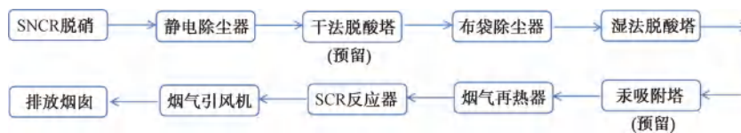
图7 东莞某污泥焚烧项目烟气处理工艺
