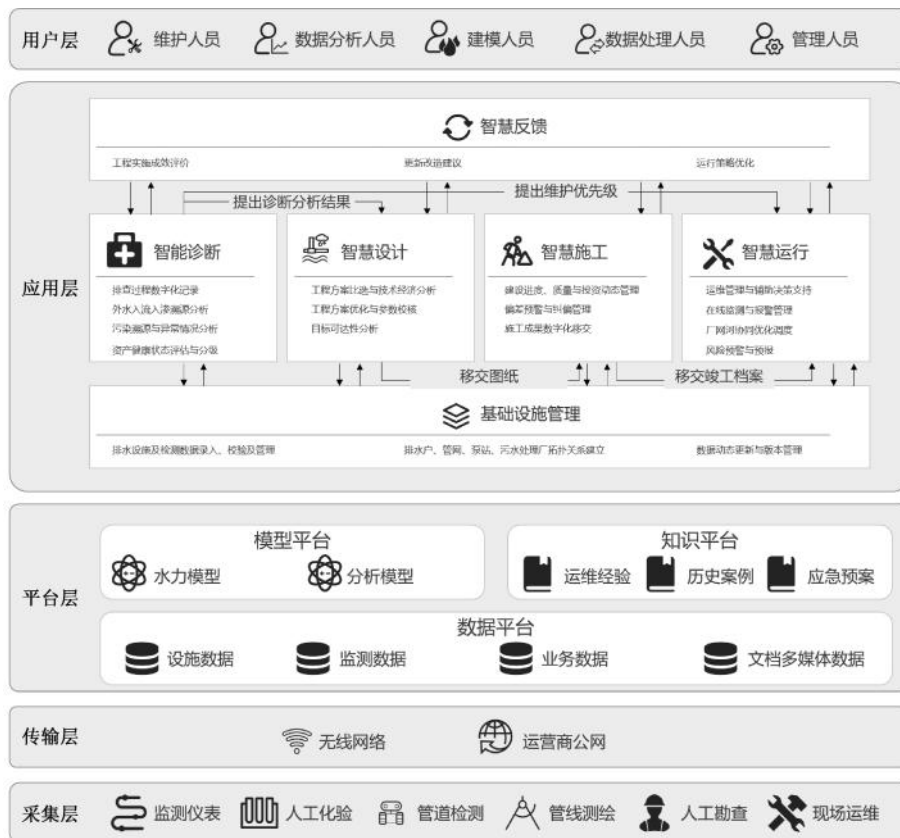
图 1 排水系统全过程数字化管控系统架构
